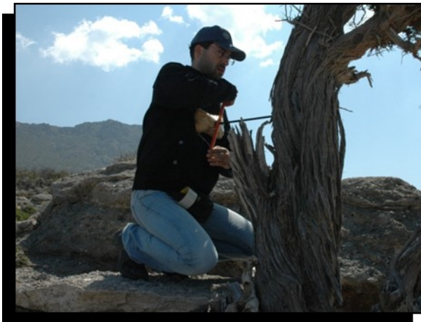
Εικόνα 9. Λήψη δείγματος κορμού για δενδροχρονολόγηση, με χρήση τρυπανιδίου.
